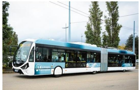
L'un des trois derniers trolleybus réceptionnés par les TCL, un Crealis 18 « In-Motion charging »
